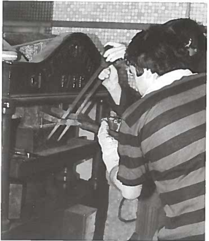
La charge de plaques doublées mise en place sous la presse.
