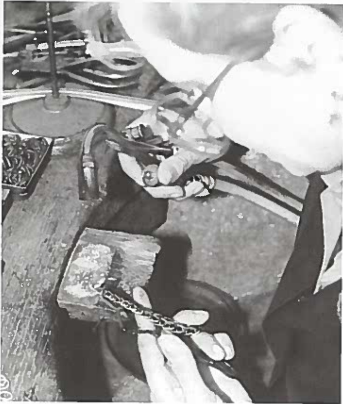
L'opératrice apporte un grand soin à réaliser la brasure d'une chaîne palmier.
